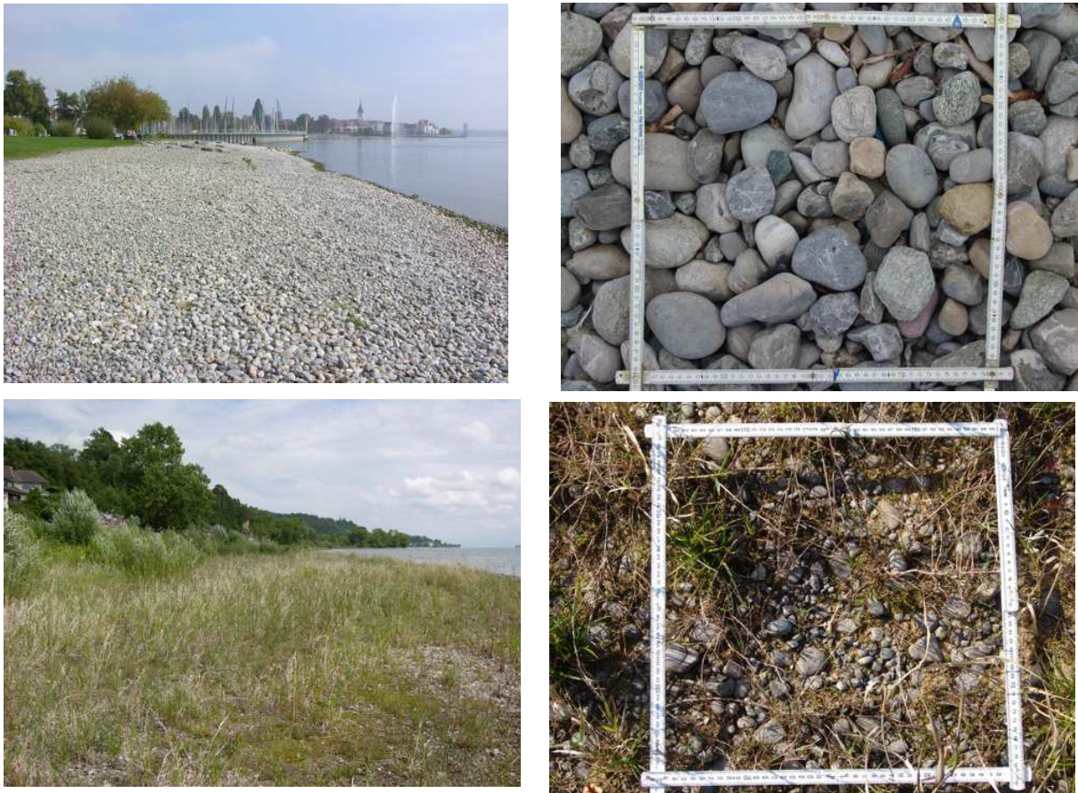
Abbildung 5: Ökologische Auswirkungen der Substratwahl bei Uferanschüttungen. Oben - Mauervorschüttung am Zeppelin-Haus in Friedrichshafen mit gewaschenem Kies ca. 32/100 mm Korngröße: Das Material ist wasserbaulich stabil, aber aus ökologischer Sicht lebensfeindlich. Unten - Mauervorschüttung am östlichen Ortsrand von Sipplingen mit ungewaschenem Wandkies mit breitem Korngrößenspektrum: In kurzer Zeit hat sich eine dichte Vegetationsdecke aus Strandrasen-Arten, Binsen, Seggen, Rohrglanzgras und Schilf gebildet, das die Substratoberfläche vor Ausspülung schützt.
