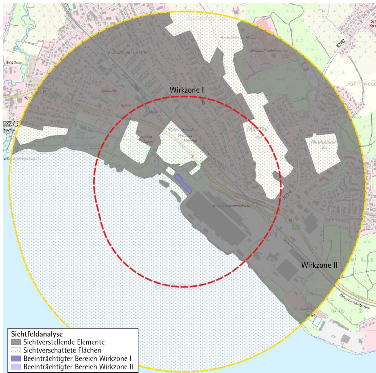
Abbildung 11: Sichtfeldanalyse. (Quelle: Topographische Karte: LUBW Daten- und Kartendienst online, digital ergänzt durch 365° freiraum + umwelt)
