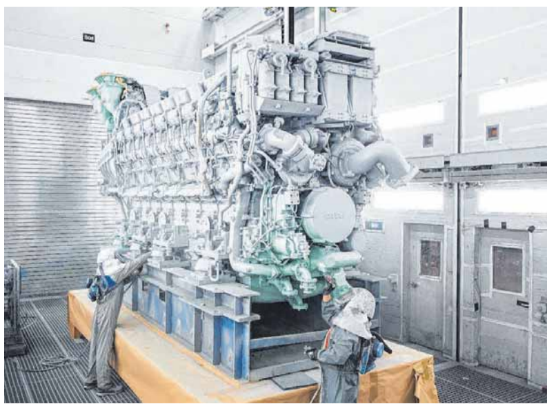
Rolls-Royce hat erstmals 16-Zylinder-Motoren der erfolgreichen MTU-Baureihe 8000 ausgeliefert. Das Bild zeigt die Lackierung des ersten 16V 8000 kurz vor seiner Auslieferung. Mit einer Höhe von über drei Metern sind die Motoren der Baureihe 8000 die größten und stärksten der Marke MTU. FOTO: ROLLS-ROYCE
